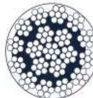
El cable Galvanizado cuenta con un recubrimiento de zinc sobre hierro o acero, por inmersión en un baño de zinc fundido. El proceso de galvanizado tiene como principal objetivo evitar la oxidación y corrosión que la humedad y la contaminación ambiental pueden ocasionar.
